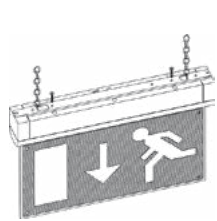
Потолочное крепление на цепь (гибкий подвес ST 50)
