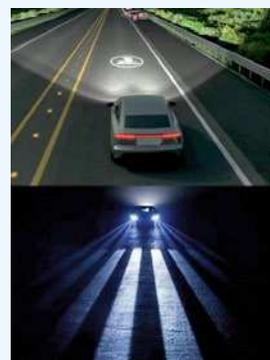
женных СД, отражается с помощью 1,3 миллиона цифровых зеркал, проецируя на поверхность дороги желаемые формы и символы. СД можно управлять индивидуально, чтобы проецировать чёткую информацию на дорогу независимо от дорожных условий.
